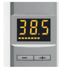
LCD-Display mit der Anzeige des Leistungsverbrauchs
